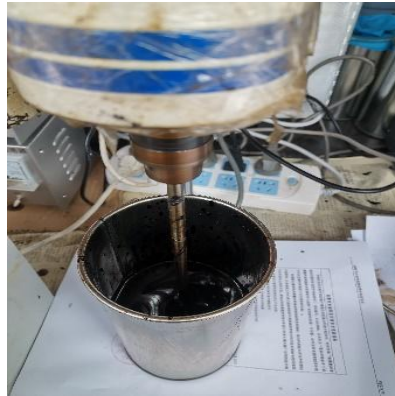
图 1 溶剂型沥青胶浆制备流程
