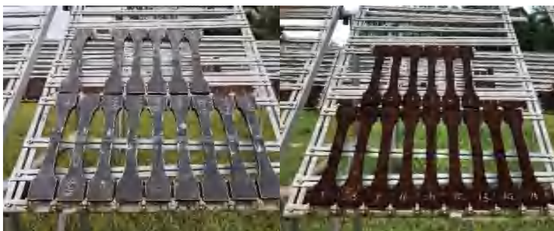
图 2 耐候钢大气暴露试验
