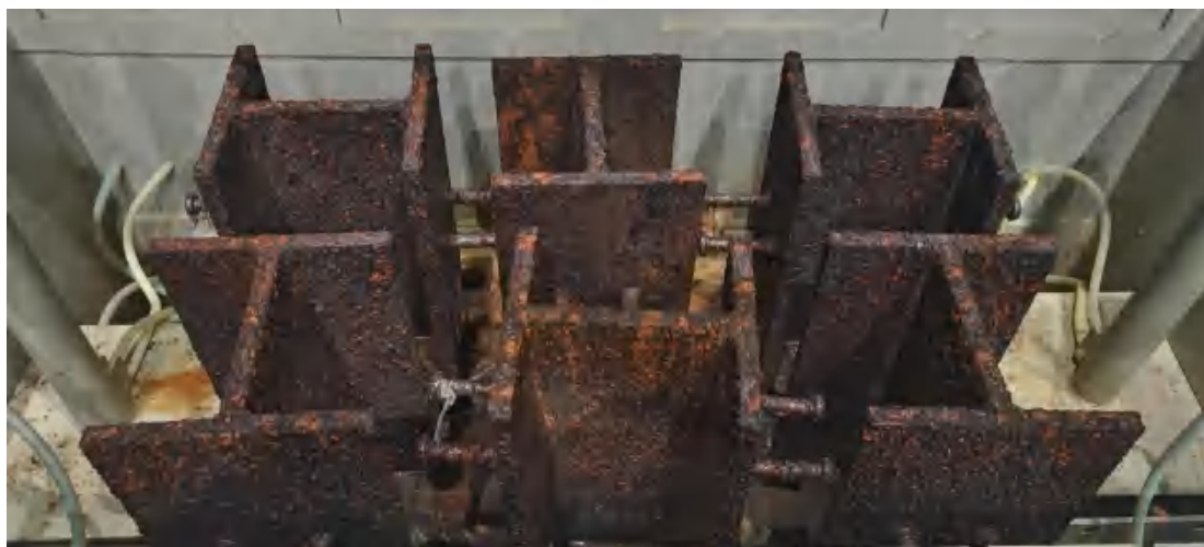
图 1 耐候钢人工加速腐蚀试验
